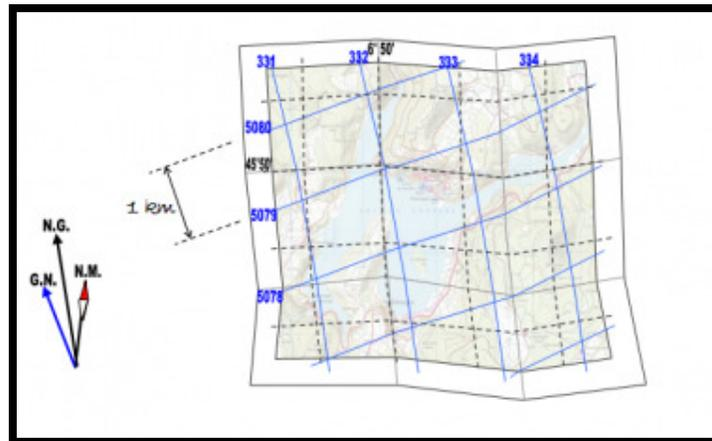
Les cartes IGN récentes [1] sont munies d'un quadrillage particulier (le quadrillage UTM) qui correspond à un découpage particulier de la Terre. Le nord du quadrillage est la direction des lignes de ce dernier (en allant vers le haut de la carte). Le Nord du quadrillage est parfois noté G.N. Pour Grid North.
