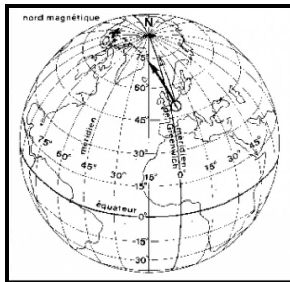
Le Nord magnétique est le Nord que t'indique ta boussole. Attention ce n'est pas tout à fait le même que le Nord vrai : le Nord magnétique se déplace très lentement au cours du temps. L'angle entre la direction du Nord vrai et celle
